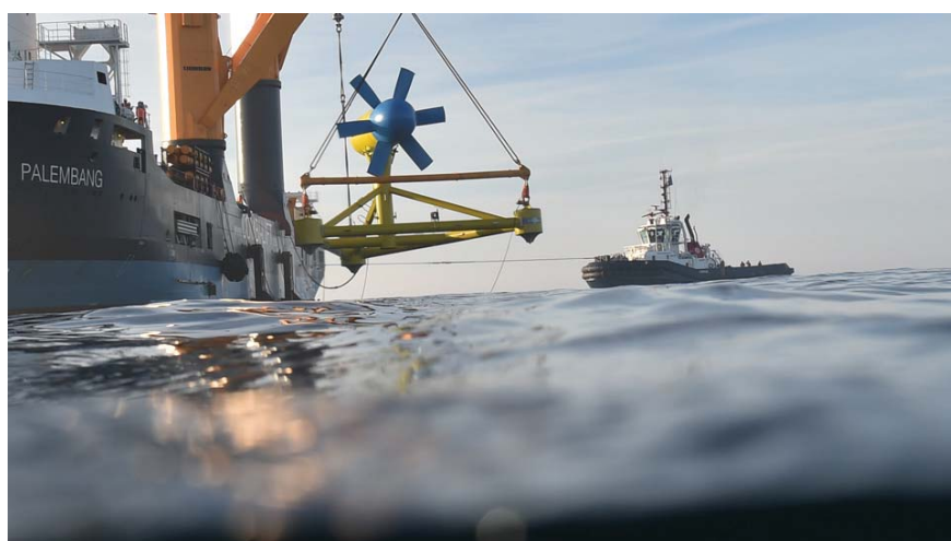
Immersion de l'hydrolienne Sabella D10 dans le Fromveur (Ouessant - 06/2015) ©SABELLA-BALAO
