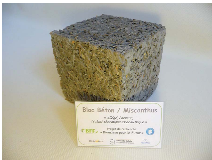
Bloc porteur Béton/Miscanthus, allégé, isolant acoustique et thermique. © Doc. Alkern-Calcia
